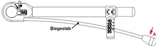
Den Druck auf das Bauteil A in Pfeilrichtung aufbringen. Das gewünschte Drehmoment ist erreicht, wenn sich die Mitte des Biegestabes mit dem entsprechenden Skalenstrich deckt. **ACHTUNG:** Ablesung immer direkt von oben.
